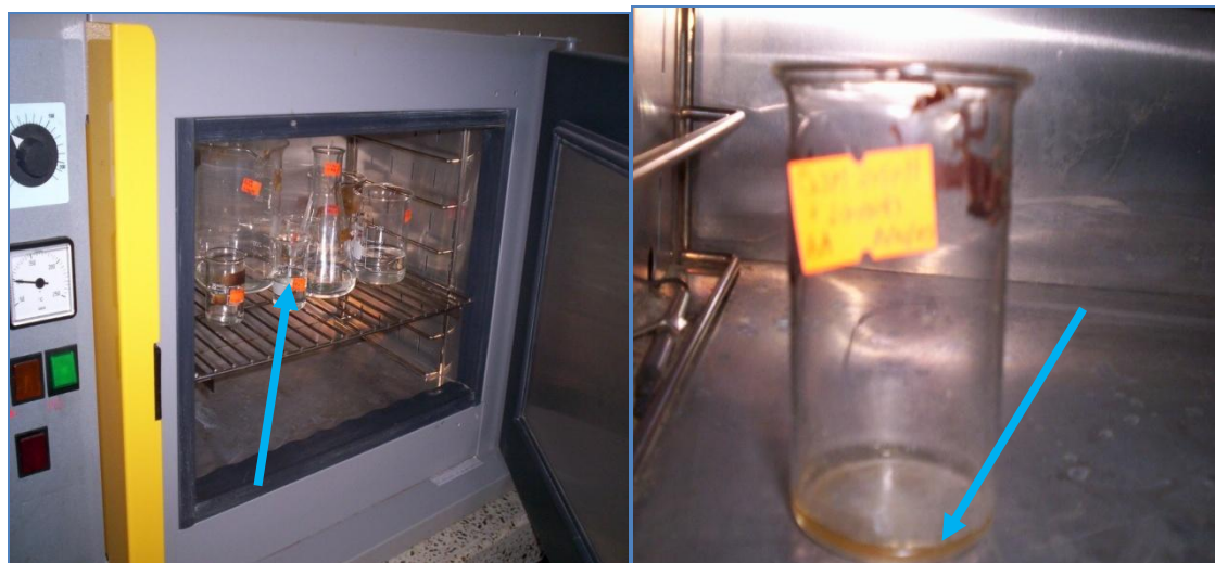
Figura 2.8. Fotografías de las síntesis de ZnO utilizando ácido acético como solvente. (a). Secado del sistema a 100°C, (b). Muestra obtenida después de 6 horas de secado.
