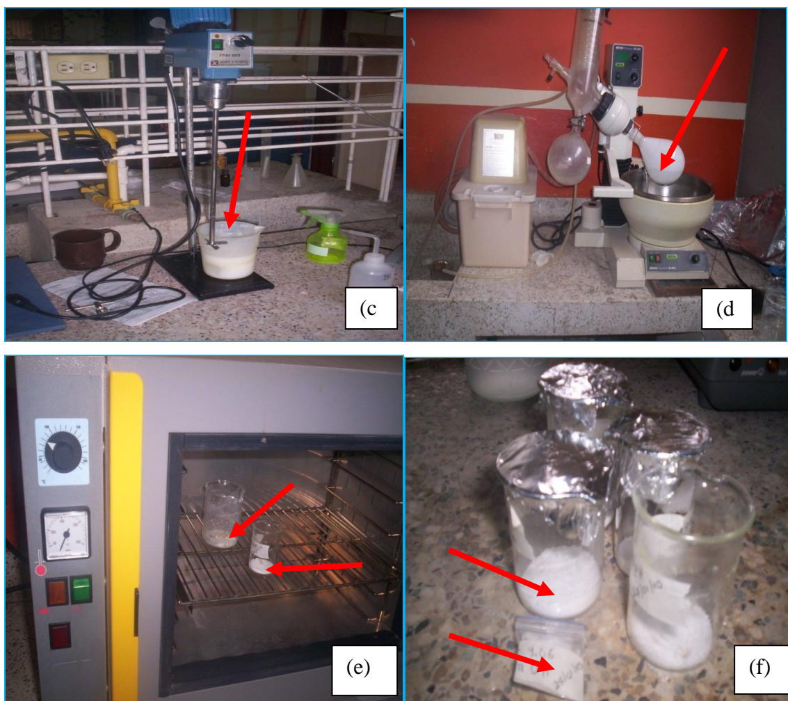
Figura 2.6. Fotografías de las diferentes etapas del método de precipitación controlada, utilizadas para sintetizar el ZnO utilizado en este trabajo. (a). Adición del hidróxido de amonio, (b). Muestra después de 15 días de envejecimiento, (c). Lavado de la muestra, (d). Eliminación de la fase líquida, (e) Tratamiento térmico, y (f) Polvos de ZnO obtenidos.
