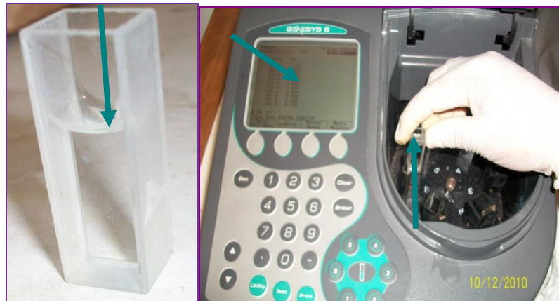
Figura 4.10. Fotografías del desarrollo experimental utilizado para en el proceso de fotodegradación del azul de metileno por los sistemas ZnO y ZnO/SnOx.
