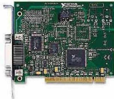
Figura B.4. Tarjeta GPIB-PCI para PC.
