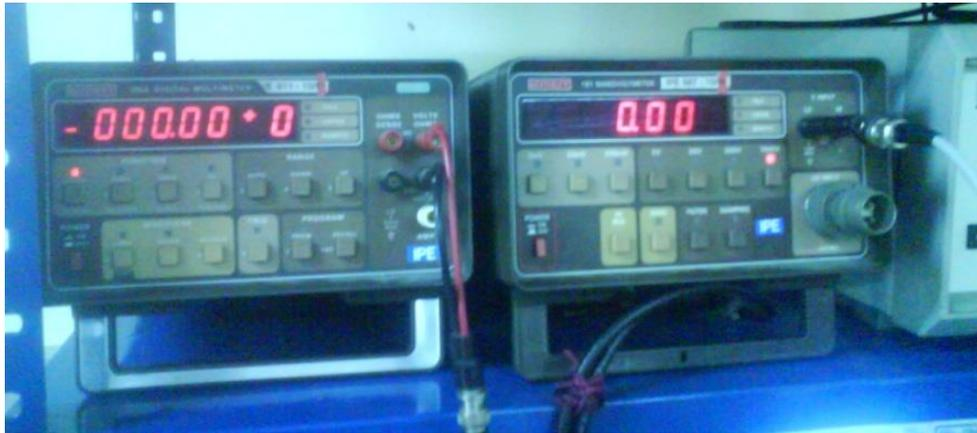
Figura 3.5. Dispositivos de medición de las salidas del *Lock-in* para la adquisición de datos por GPIB
