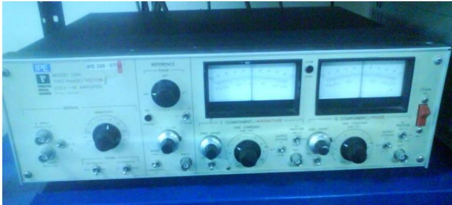
Figura 3.4. Amplificador *lock-in* PAR 129a
