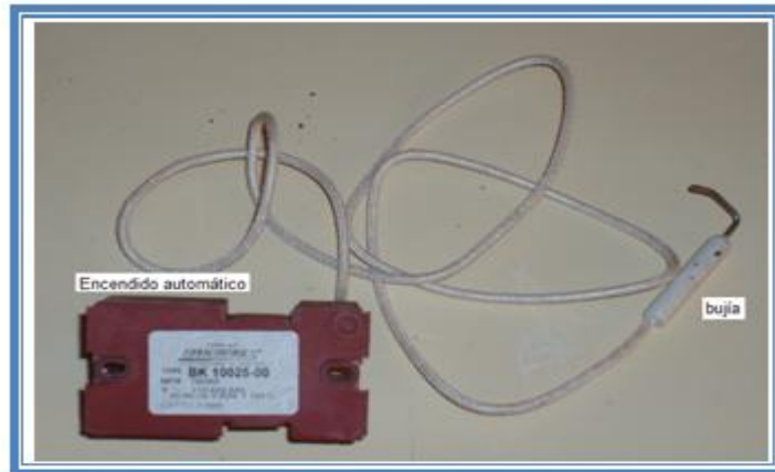
Figura 4. Encendido automático y bujía
