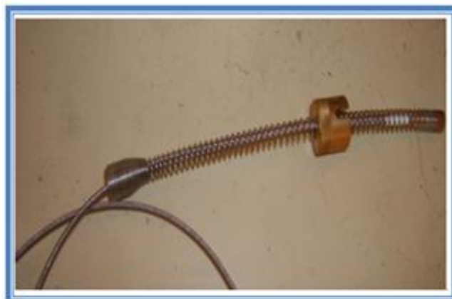
Figura 28. Sensor de temperatura (Termocupla tipo J)
