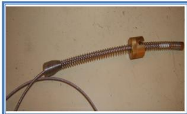
Figura 5. Sensor de temperatura (Termocupla tipo J)
