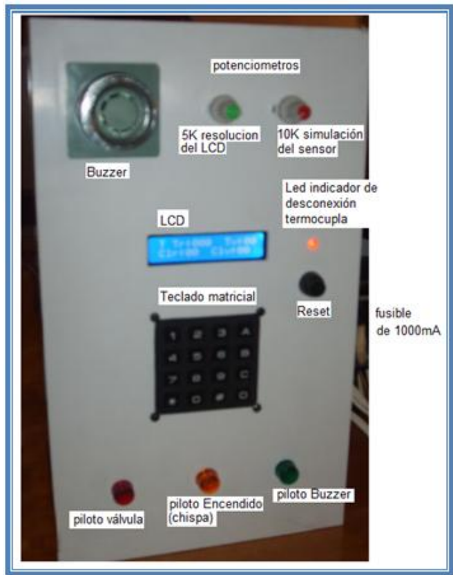
Figura 37. Montaje final del control de temperatura (exterior)
