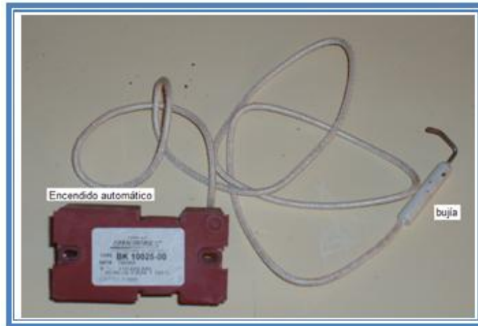
Figura 30. Encendido automático y bujía
