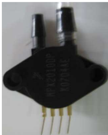
Figura 4.2. Sensor de presión MPX2010
