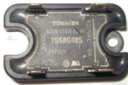
Figura 4.9. Relé de estado sólido TSS8G48S
