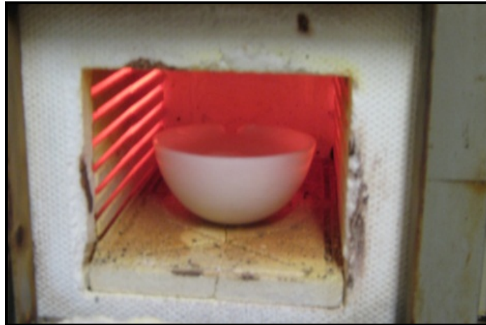
Figura 2.4 Horno empleado para la reacción de combustión.
