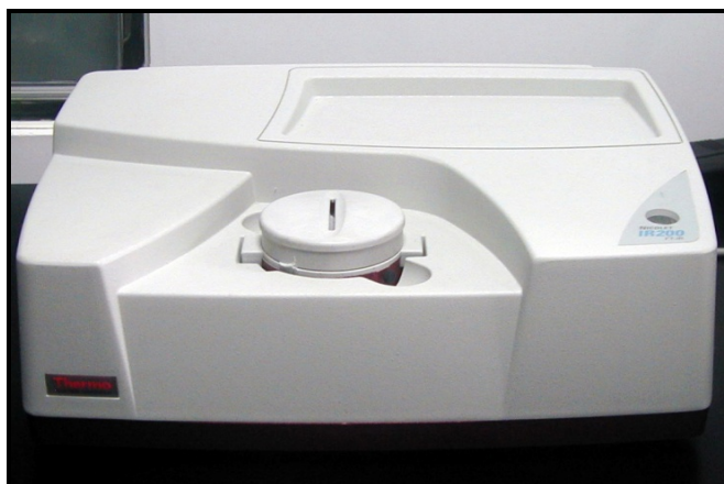
Figura 2.5 Espectrómetro de Infrarrojo (FTIR), marca Thermo Nicolet IR200, utilizado en este trabajo.
