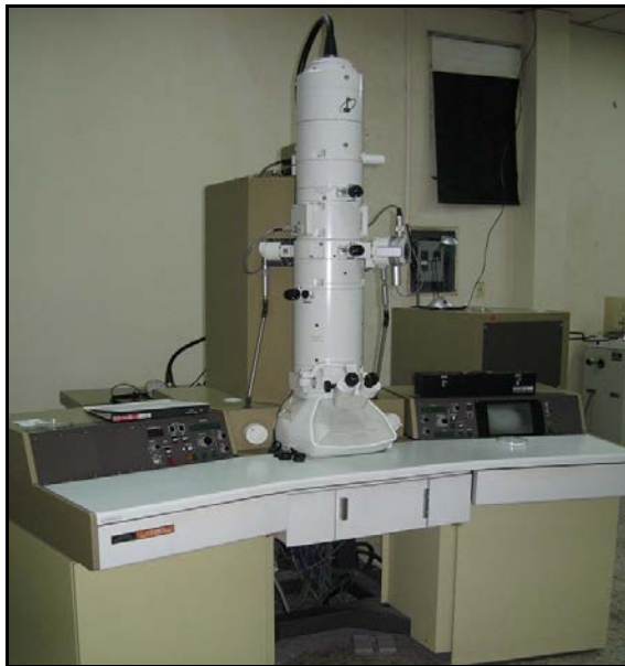
Figura 2.7. Microscopio electrónico de transmisión (MET), marca JEOL JEM-1200 (Unidad de Microscopia Electrónica – Unicauca), utilizado en este trabajo.
