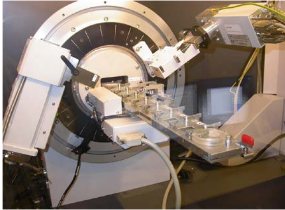
Figura 2.6 Difractómetro marca BrukerD8 Advance , utilizado en este trabajo.
