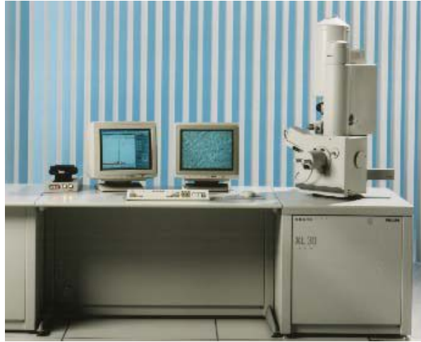
Figura 2.8. Microscopio electrónico de Barrido, marca Philips modelo XL30-FEG (Universidade Federal de Sao Carlos, Brasil), utilizado en este trabajo.
