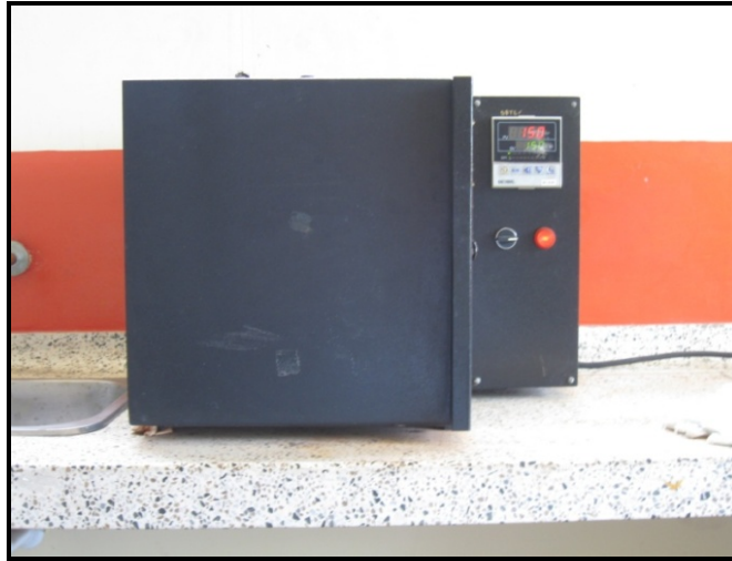
Figura 2.2 Horno Max-Thermo utilizado para el tratamiento térmico de los polvos cerámicos.
