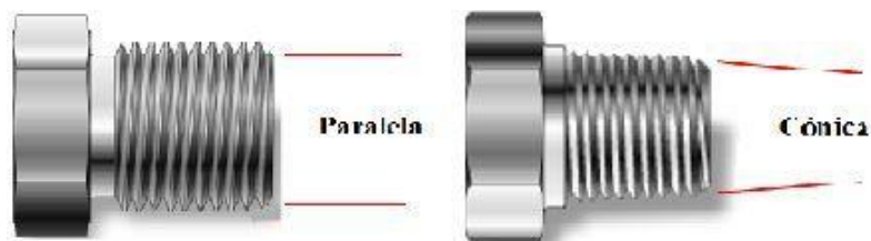
Figura 7.1. Roscas paralelas y cónicas
