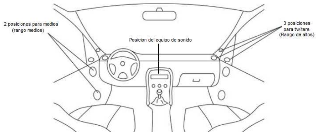
Figura 52. Posiciones del radio y parlantes como twiters y medios dentro de un vehículo.
