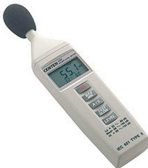
Figura 11. Sonómetro Digital Modelo: MSL-1325 Instrumento digital portátil, con LCD de 4 dígitos, de acuerdo con la norma IEC651 Tipo II, con registro de máximo y mínimo, respuesta rápida (FAST) y lenta (SLOW), micrófono de electreto de 1/2", rango dinámico de 50dB, precisión de \pm 1.5\text{dB} (94dB/1kHz), ponderación A y C en frecuencia y rango de medida de 32dB a 130dB en tres rangos (Lo, Med y Hi). Utilizado en mi practica laboral.
