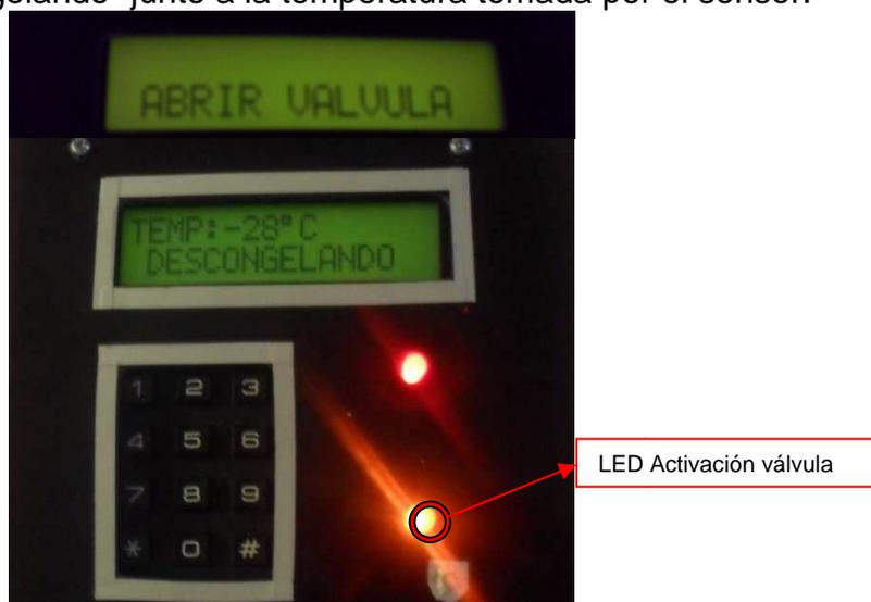
Figura 24. Pantalla LCD mostrando proceso de activación de actuador<sup>3</sup>
