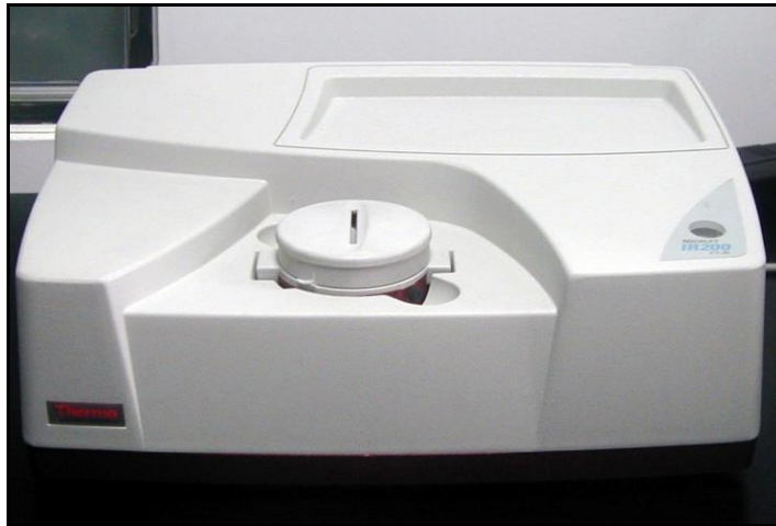
Figura 2.5 .Espectrómetro de Infrarrojo (FTIR), Termo Electrón Nicolet IR200
