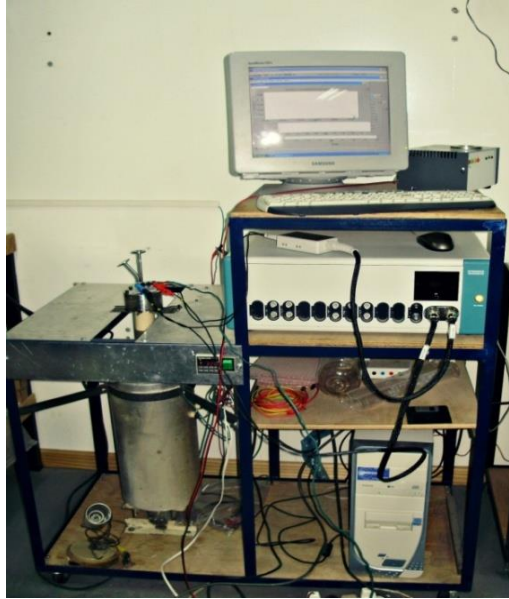
Figura 2.8. Impedancímetro perteneciente al laboratorio de caracterización de materiales del Centro atómico de Bariloche.
