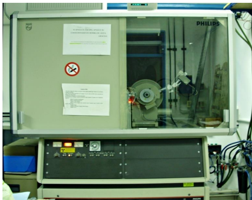
Figura 2.6.Difractómetro de Rayos X Philips, modelo PW3710.
