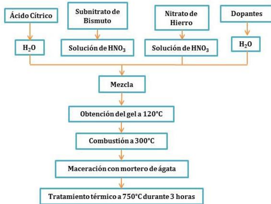
Figura 2.3 Esquema del método gel-citrato utilizado para la obtención de los polvos cerámicos \text{Bi}_{1-x}\text{La}_x\text{FeO}_3 , \text{BiFe}_{1-y}\text{Co}_y\text{O}_3 y \text{Bi}_{1-x}\text{La}_x\text{Fe}_{1-y}\text{Co}_y\text{O}_3
