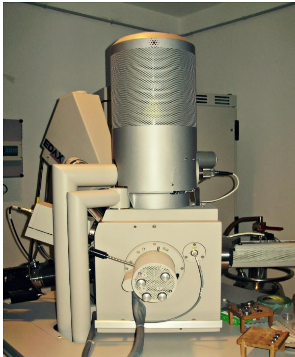
Figura 2.7. Microscopio Electrónico de Barrido FEI modelo Nova Nano SEM 50 series.
