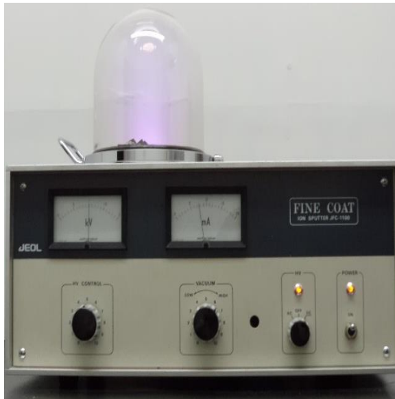
Figura 2.15. Equipo utilizado para electrodar las muestras de SBN50-Co. (FINE COAT Ion Sputter JFC 1100).
