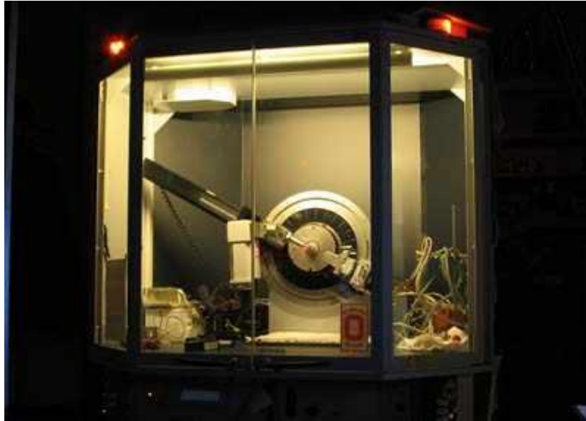
Figura 2.11. Difractómetro Bruker D8 Advance utilizado para la caracterización de los polvos cerámicos.
