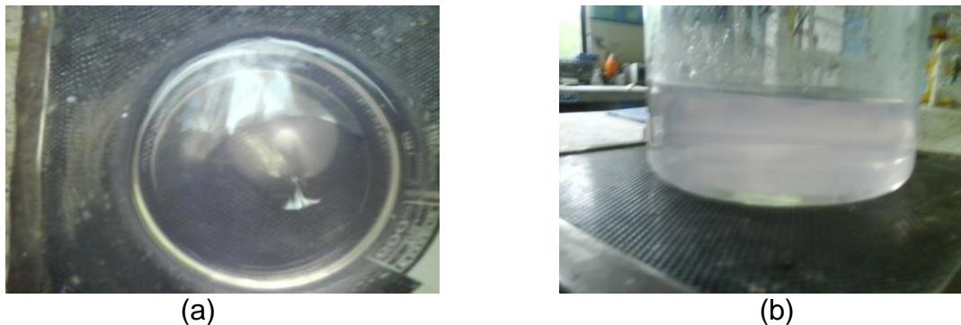
Figura 2.5. (a) Solución traslúcida y homogénea de los reactivos, (b) mezcla de reactivos puesta en una plancha en continua agitación.
