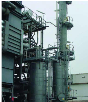
Figura 7.4: sistema de reformado industrial de gas natural.
