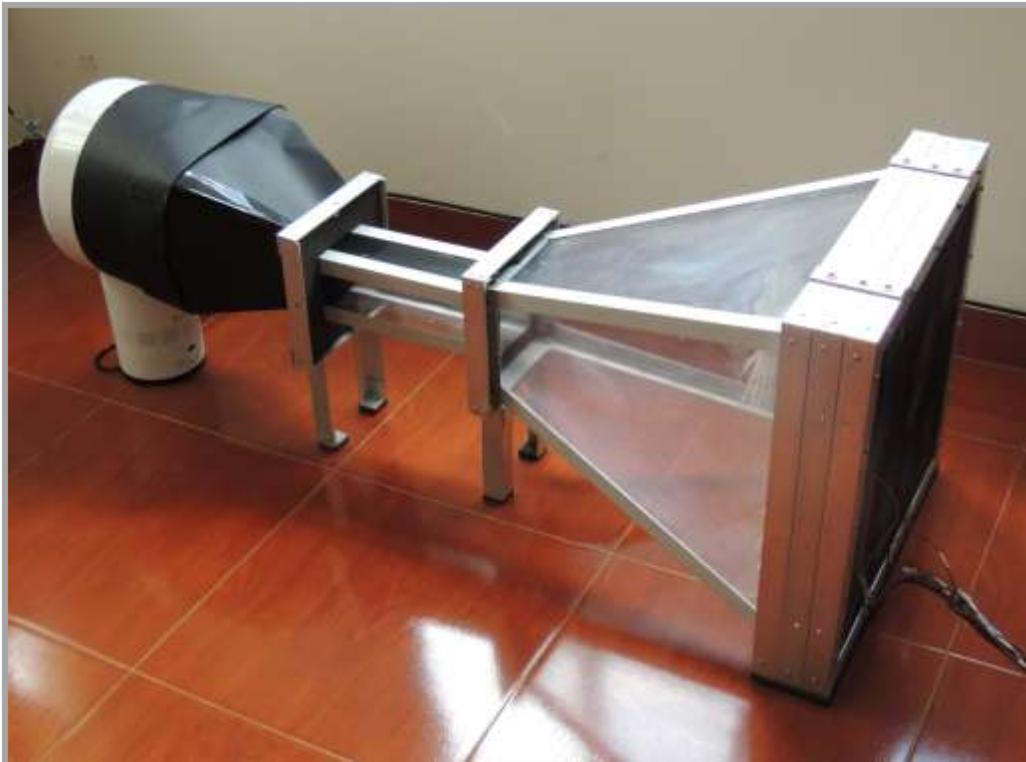
**Figura. 2.4. Prototipo de Túnel de viento subsónico bajo para pruebas de instrumentación.**
