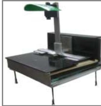
Figura 5.4. Balanza aerodinámica para determinación de perfiles aerodinámicos.
