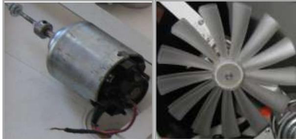
Figura 2.6. Motor central y hélices para la zona de aspirado.
