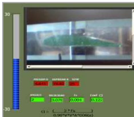
Obtención de  $C_L$  para el Perfil CLARK Y con  $\text{Alpha}=2^\circ$
