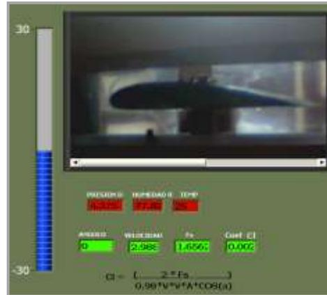
Obtención de  $C_L$  para el Perfil CLARK Y con  $\text{Alpha}=0^\circ$
