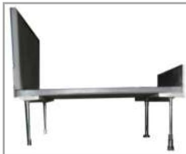
**Figura 5.1. Base soporte para balanza aerodinámica**
