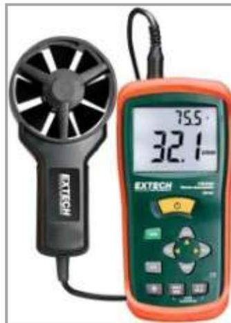
**Figura 3.5. Anemómetro Extech para calibración de sensor de presión.**
