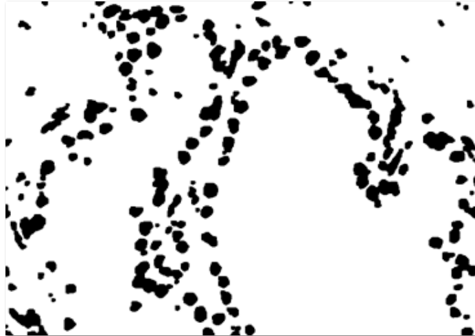
Figura 25. Resultado de aplicar apertura morfológica a la imagen con agujeros relleno.
