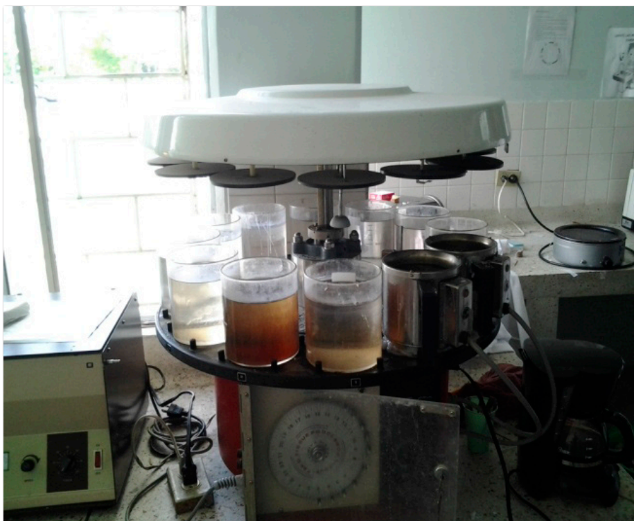
Figura 13. Procesador de tejidos con 3 baños de alcohol 96% 5 baños de alcohol al 100% y dos baños de xilol
