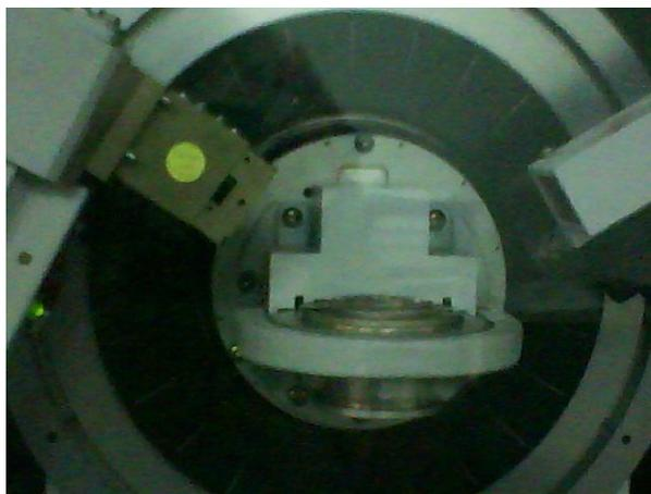
Figura 3.2. Equipo de difracción de rayos X Bruker D8 Advance (Laboratorio de física del plasma - Universidad Nacional sede Manizales).
