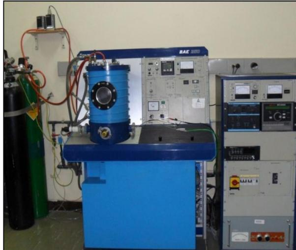
Figura 2.2. Equipo de pulverización catódica Balzers BAE 250 (Laboratorio de Física de Bajas Temperaturas - Universidad del Cauca).
