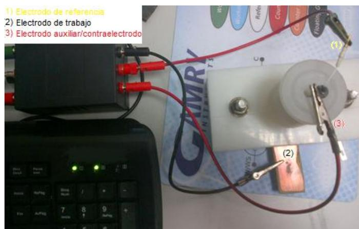
Figura 3.8. Celda electroquímica para obtención de espectros de impedancia EIS (Laboratorio de Física de la Universidad Nueva Granada - Sede Bogotá).
