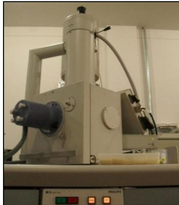
Figura 3.4. Equipo de microscopía electrónica de barrido ESEM XL30 TMP (Laboratorio de Física del Plasma de la Universidad Nacional de Colombia - Sede Manizales).
