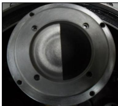
Figura 2.3. Blanco binario de Titanio/grafito empleado para la producción de recubrimientos compuestos de TiCN.
