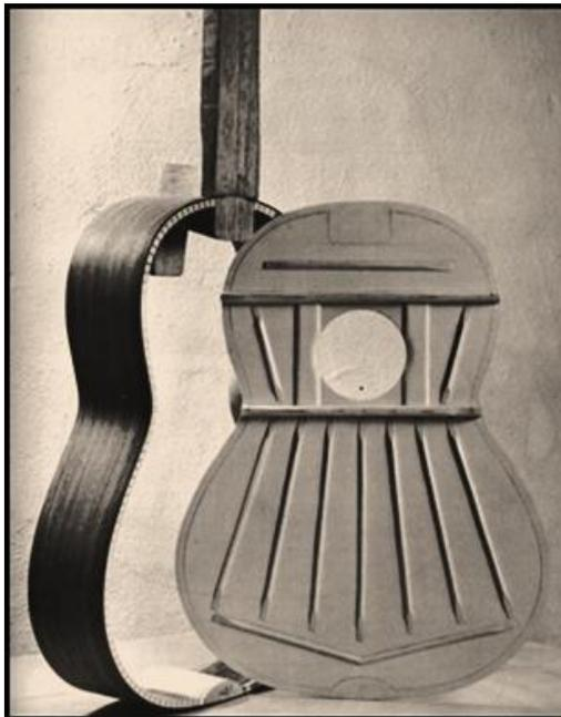
Figura.0.1. Partes importantes en la producción del sonido en la guitarra: la caja de resonancia y la tapa con su sistema de armónicos.
