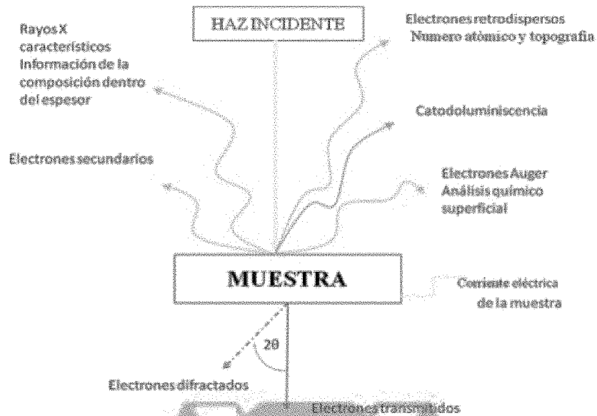
Figura 3.3. Interacción de los electrones con la muestra dentro del Microscopio Electrónico de Barrido (Tomada de [4]).
