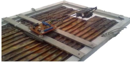
**Figura 12. Instalación del intercambiador placa-tubo de cobre.**
