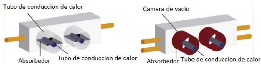
Figura H.6 Tipo de colector solar térmico de vacío.
