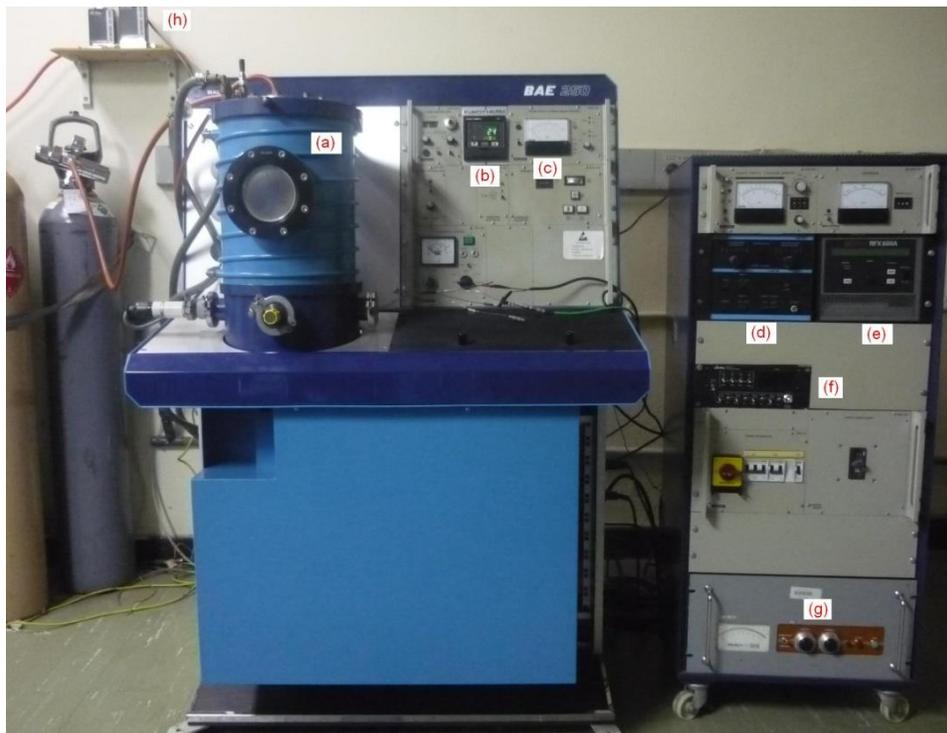
**Figura 2.3:** Sistema magnetrón sputtering Balzers BAE 250. (a) Cámara de vacío, (b) controlador de temperatura, (c) indicador de presión del manómetro Pirani, (d) red de acople de impedancias, (e) fuente R.F, (f) controlador digital de los fluxómetros, (g) fuente de corriente y (h) controladores de flujo o fluxómetros.
