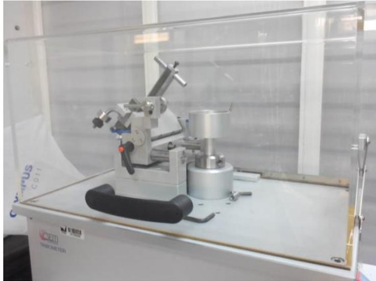
**Figura 2.8:** Tribómetro con el que se realizó el ensayo de ball on disk.
