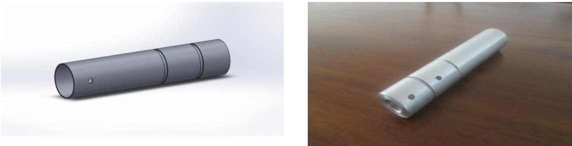
Figura 8 Izquierda modelo virtual de la camisa; derecha pieza maquinada.
