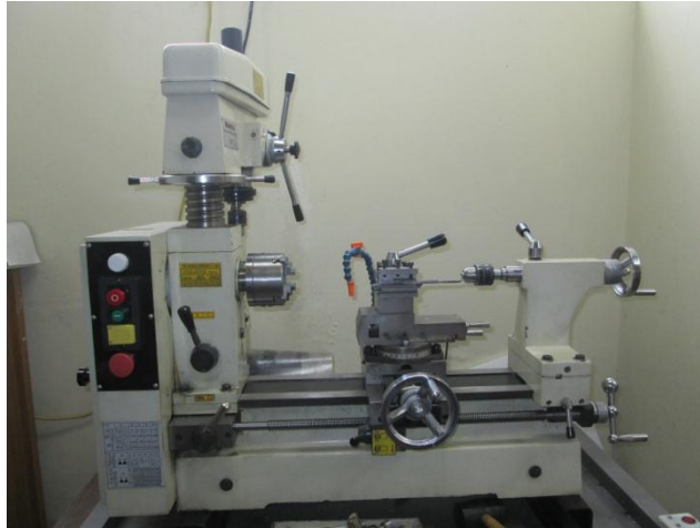
Figura 12 Torno para metales del taller del Grupo de investigación
