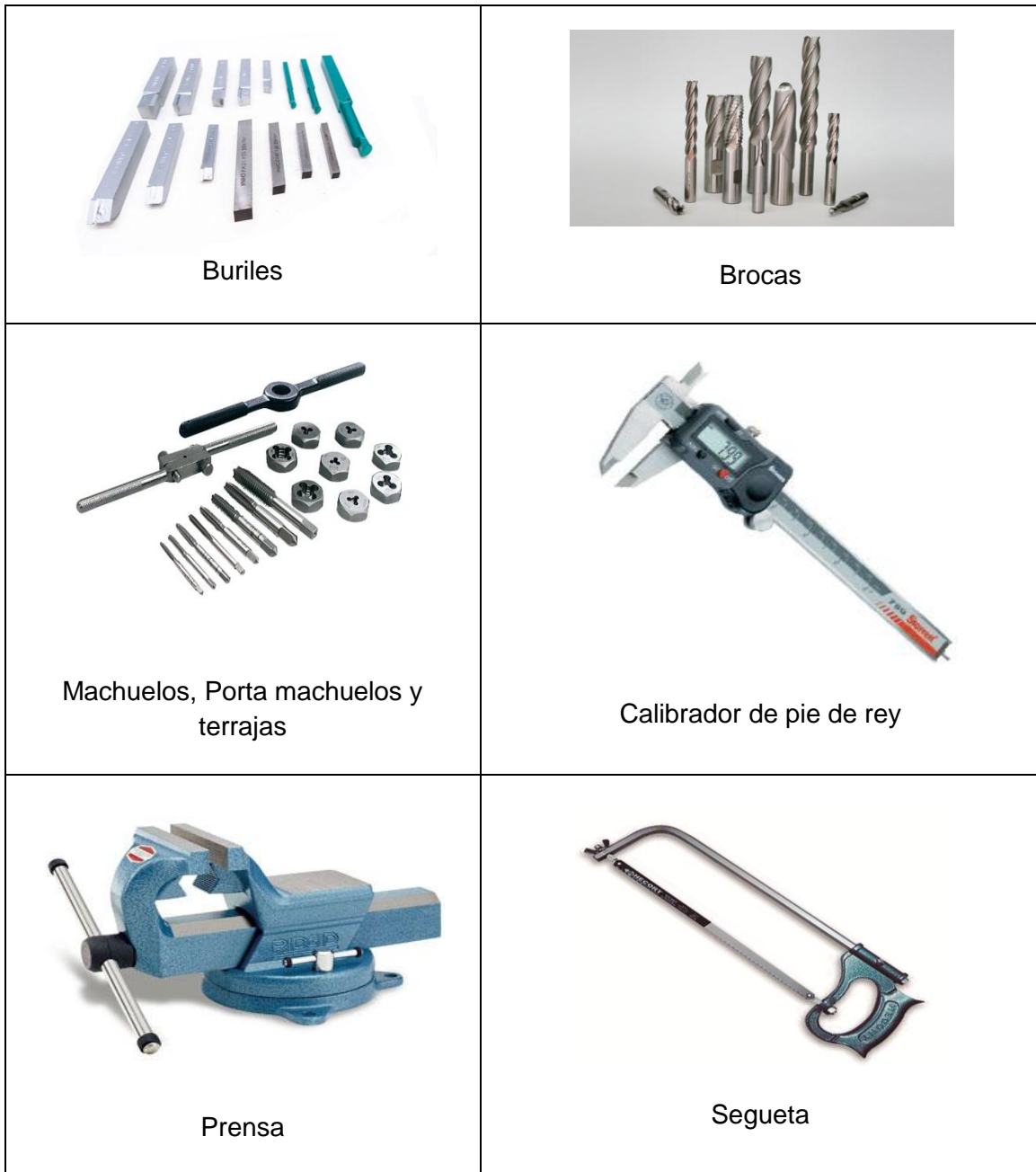
Figura 15 Herramientas de corte y de medición usadas en la construcción de la válvula proporcional
