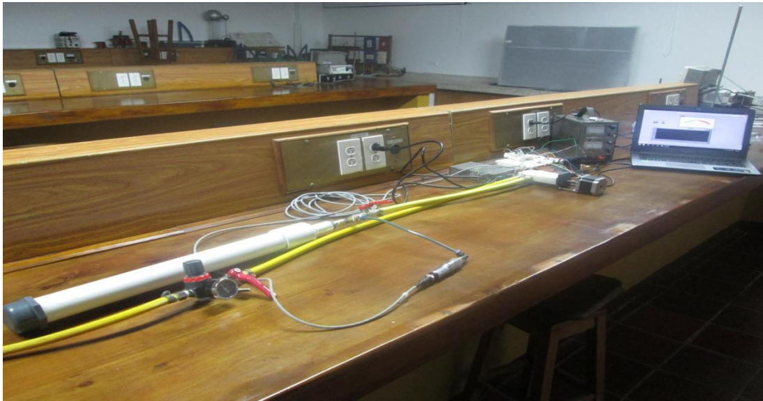
Figura 31 Esquema e imagen de prueba de caracterización Pasos versus Presión
