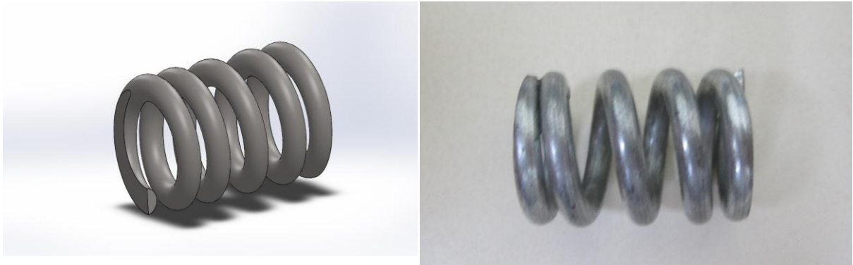
Figura 5 Modelo virtual del resorte de regulación (Izquierda). Pieza usada (Derecha)
