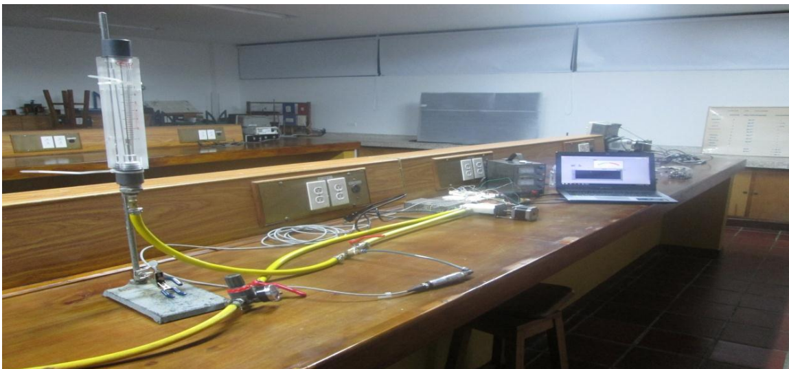
Figura 33 Esquema e imagen de prueba de caracterización función caudal versus presión.
