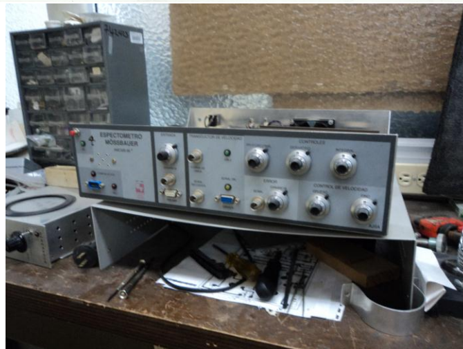
Figura 39. a) Esquema parte frontal Analizador multicanal. b) Panel frontal del Analizador Multicanal del espectrómetro Mössbauer del GMTF Universidad del Valle, con los respectivos salidas y entradas para los cables de comunicación.
