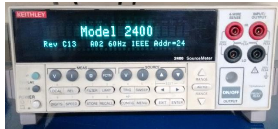
Figura A1- 13: Fuente de corriente y medidor de voltaje Keithley 2400.
