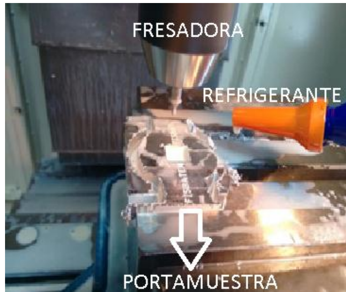
Figura A1- 9: Sistema CNC para el diseño del porta muestrade aluminio
