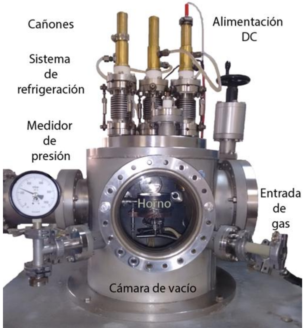
Figura 0-4: Componentes del sistema sputtering DC.
