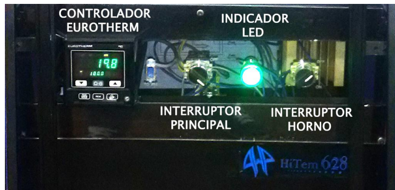
Figura A1- 5: Panel de control sistema HiTem628.
