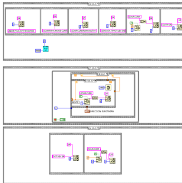
Figura A1- 11: Diagrama de bloques diseñado en labVIEW para el sistema controlador de temperatura HiTem628.
