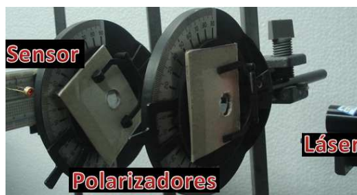
Figura 2.14 Montaje para caracterizar los sensores.
