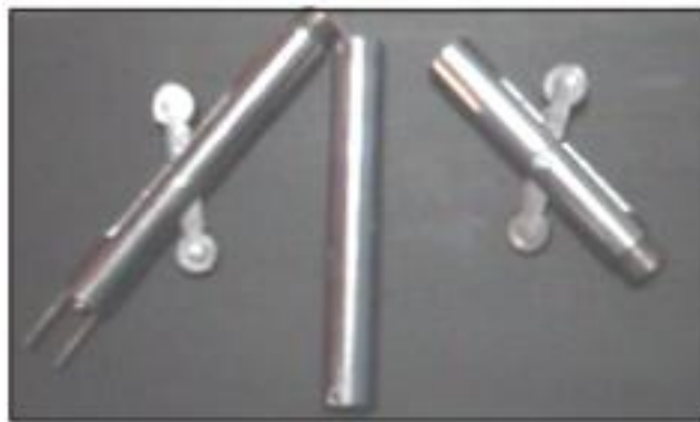
Figura 5.1 Partes de la sonda de inmersión
