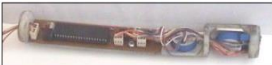
Figura 5.3 Esquema interno de la sonda de inmersión
