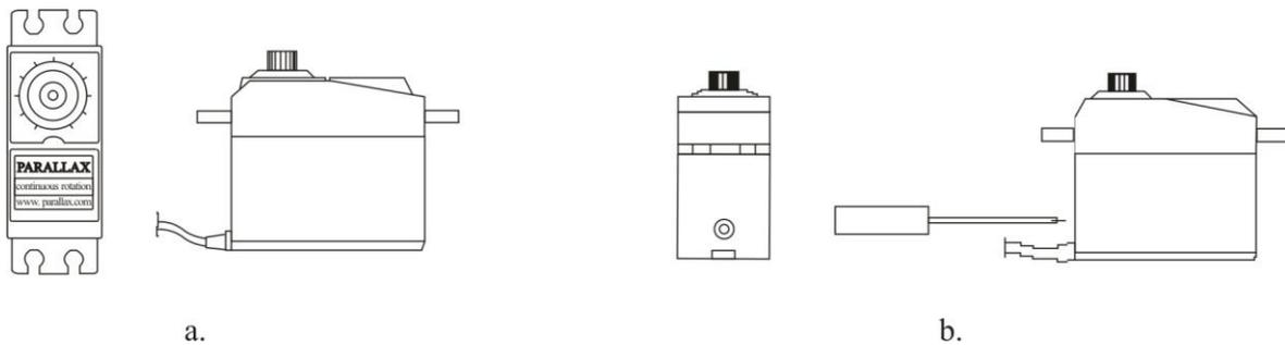
**Figura 3.5.** a. Servomotor Parallax, parte posterior y vista lateral b. Control de ajuste manual del servomotor, tornillo ubicado en la parte frontal.
