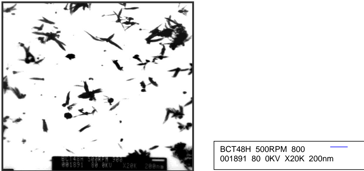
Figura 28. Micrografía electrónica de partículas de titanato de bario obtenidas por el método mecanoquímico.
