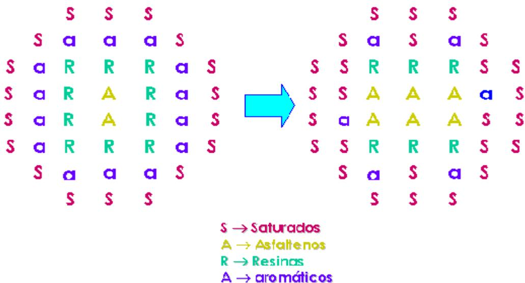
Figura 25. Diagrama esquemático de la transformación química ocurrida para el asfalto original a medida que transcurre el tiempo de almacenamiento.
