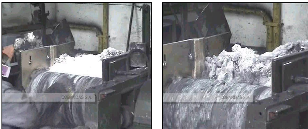
Figura 2.6. Proceso de incorporación de las sustancias al caucho
