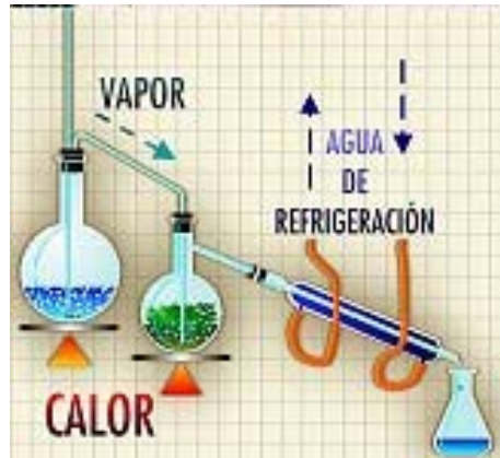
Figura 17. Equipo arrastre con vapor
