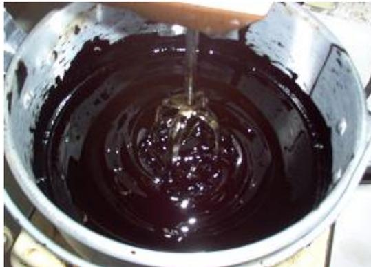
El mismo procedimiento se realizó con el látex modificado, que se muestra en la figura 17, que son: látex con  $\text{NH}_4\text{OH}$  al 3% y látex con  $\text{NH}_4\text{OH}$  al 5%. Para modificar el asfalto se le adicionó el modificador a diferentes concentraciones que son: 1, 3 y 5%, como se resume en la siguiente tabla.
