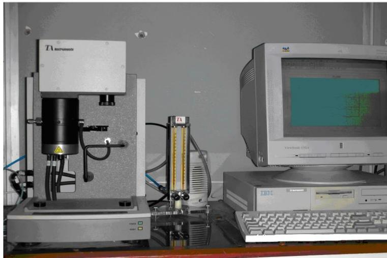
El elemento activo de medida usado en el TGA es la termobalanza, que consiste básicamente en una balanza de precisión, un horno controlado mediante un programador de temperatura y un registrador de datos. El portamuestras se encuentra dentro del horno, suspendido directamente de la balanza.<sup>58</sup>
