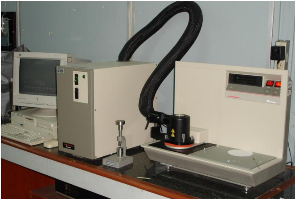
**2.3.2 Termogravimetría** En termogravimetría (TGA) el análisis de la masa de la muestra en una atmósfera controlada es medida como una función de temperatura o de tiempo. La TGA puede usarse para monitorear cualquier reacción que involucre una fase de gas como la oxidación o deshidratación. Este método es útil para determinar la pureza de la muestra o el contenido de agua.
