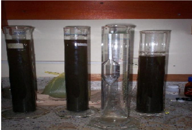
Figura 9. Determinación de textura del suelo por método de Bouyoucos.
