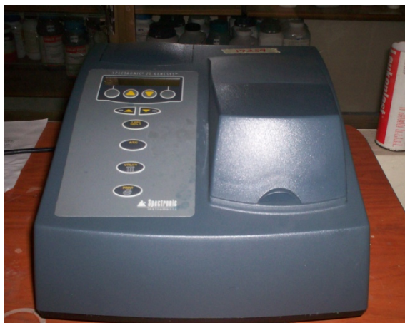
Figura 8. Determinación de fósforo. Espectrofotómetro ultravioleta visible.
