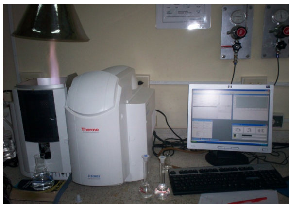
Figura 7. Determinación de bases intercambiables. Equipo Absorción Atómica.
