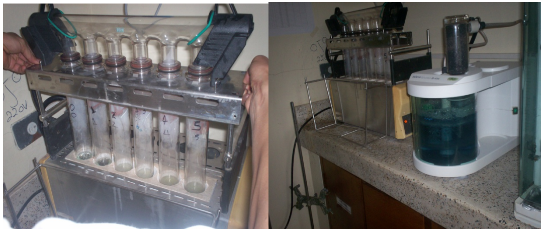
Figura 6. Determinación de nitrógeno. Método de Kjeldahl
