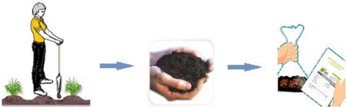
Figura 17. Muestreos realizados con barreno y almacenamiento de las muestras en bolsas de plástico para posterior traslado al laboratorio de análisis de suelos.
