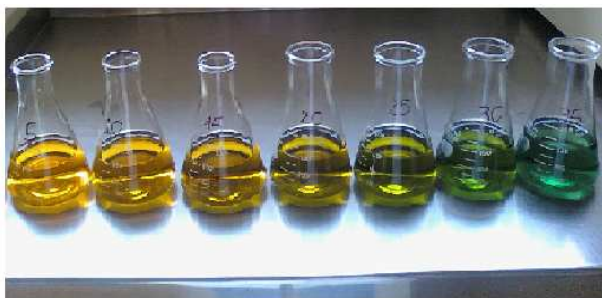
Figura 9. Curva de calibración diaria con siete niveles de concentración
