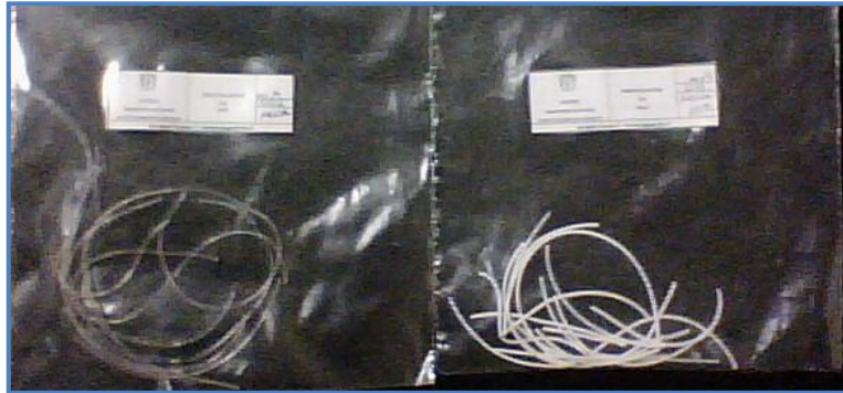
Figura 22. Polímero PLA sometido al ensayo de migración a 50°C
