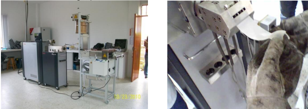
Figura 5. Equipo de extrusión por tornillo simple, Laboratorio de Reología - Facultad de Ciencias Agropecuarias
