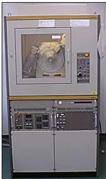
**3.5.** Difractómetro Siemens D500 empleado en los análisis.
