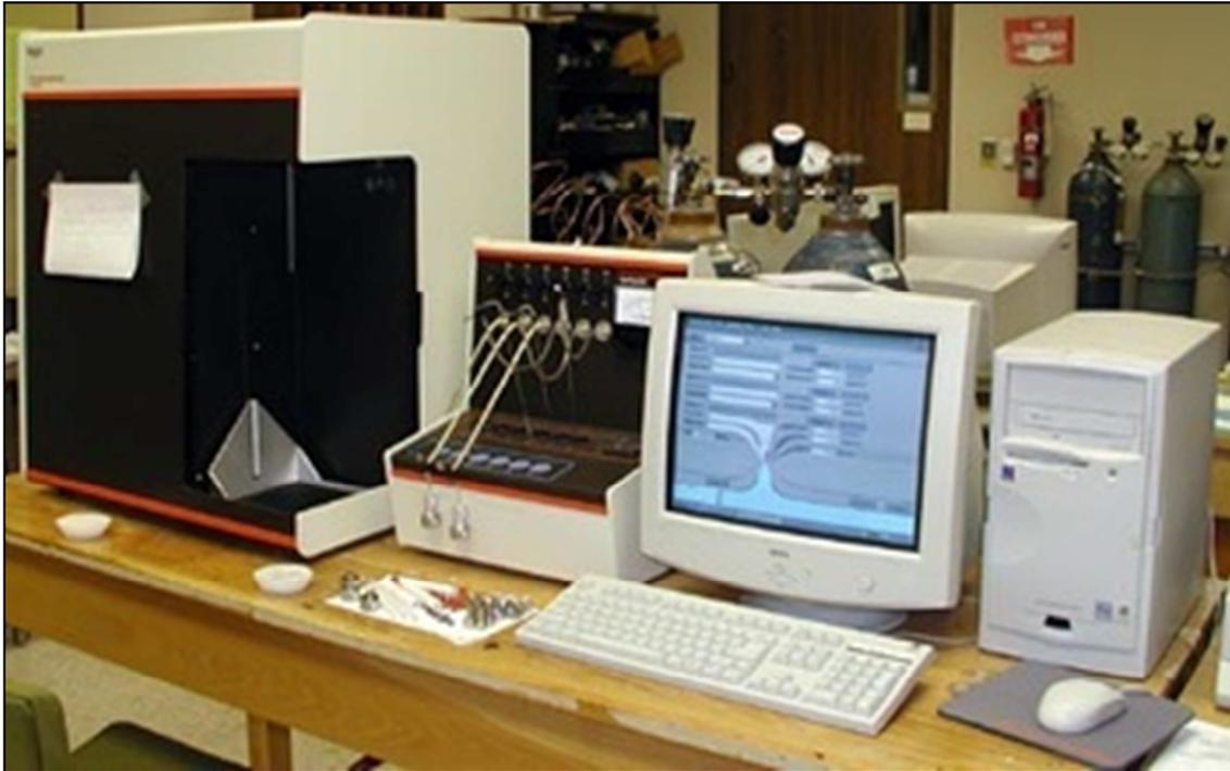
**Figura 3.6.** Instrumento TRISTAR 3000 empleado en los análisis.
