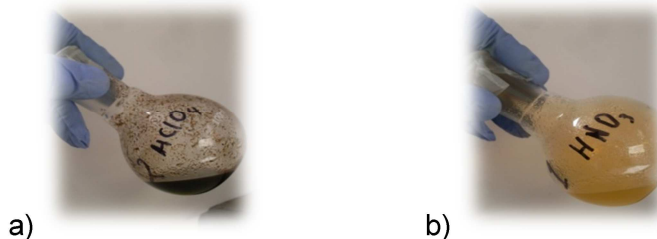
Figura 7. Digestión del termoformado (HMC-1), 1,0000 g, 70°C, 3 horas: a) HClO 4 , b) HNO 3 .
