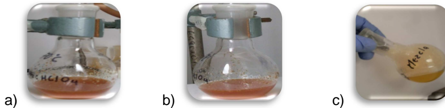
Figura 10. Digestión de termoformado HMC-1, relación 3:1, 1,0000 g, 70°C: a) 60 minutos, b) 120 minutos, c) 180 minutos.
