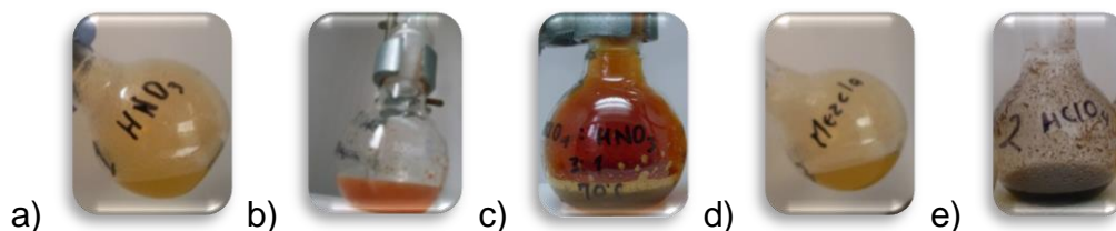
Figura 8. Digestión ácida de 1,0000 g de termoformado (HMC 1) con \text{HNO}_3:\text{HClO}_4 a 70^\circ\text{C} , durante 180 minutos en la relación de ácidos: a) 1:0, b) 1:1, c) 1:3, d) 3:1 y e) 0:1
