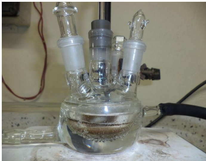
Figura 3.4. Montaje para la reacción de epoxidación del ciclohexeno
