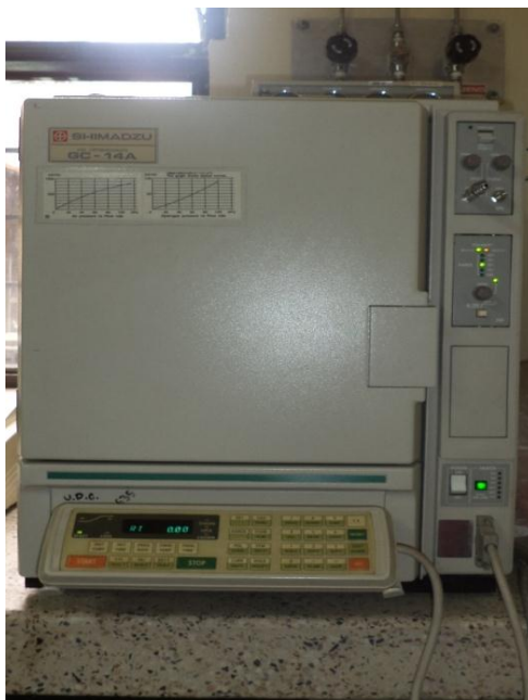
Figura 3.5. Shimadzu GC-14A equipado con un integrador CR-15A y con detector de ionización de flama (FID)
