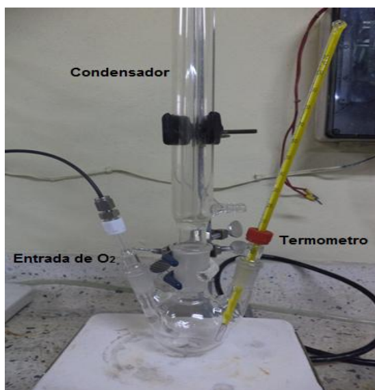
Figura 13. Montaje para la reacción de oxidación del alcohol bencílico.
