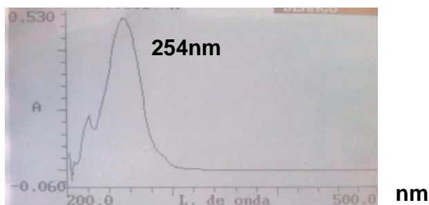
Figura 19. Espectro UV-vis de PE1 en cloroformo.
