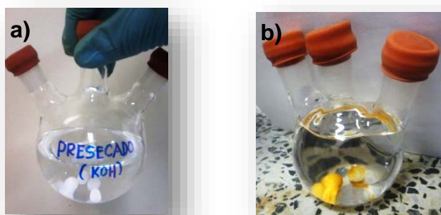
Figura 52. Proceso de presecado. a) 0 h y b) 24 h.
