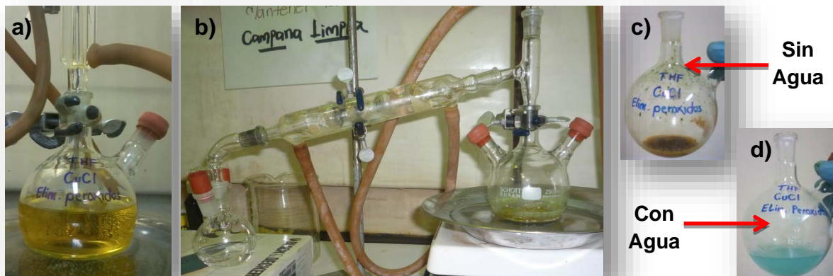
Figura 51. Eliminación de peróxidos de THF. a) Reflujo, b) destilado, c) y d) residuos.
