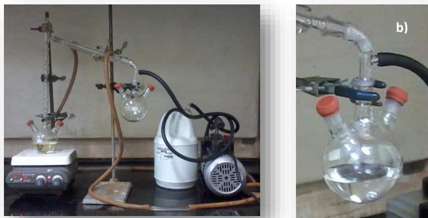
Figura 49. Destilación fraccionada del benzaldehído. a) Montaje b) benzaldehído purificado.
