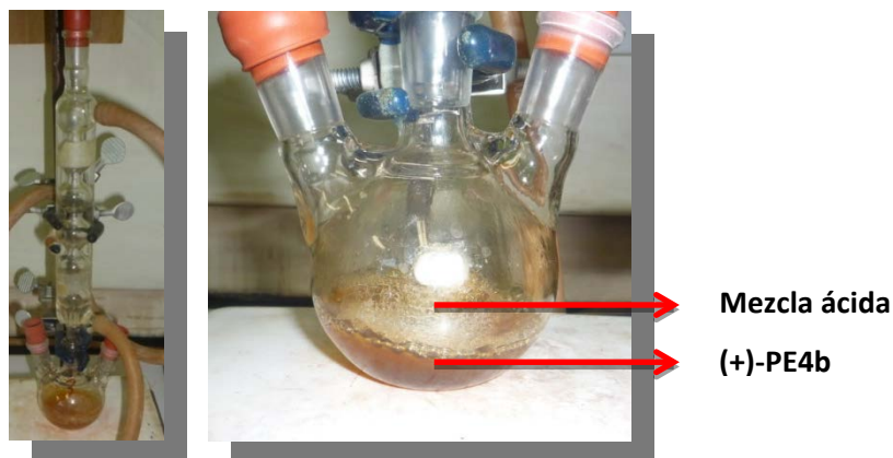
Figura 15. Montaje realizado para la síntesis de PE5b.
