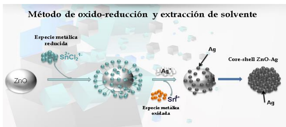
Figura 3.3. Esquema representativo de la reacción de oxidación-reducción que permitiría obtener las nanoestructuras “core-shell” de ZnO-Ag.
