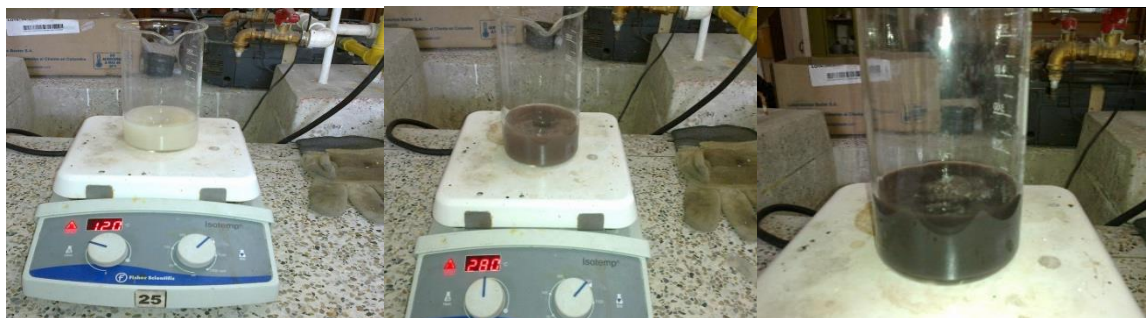
Figura 3.4. Fotografías que muestran la reacción de síntesis para obtener las nanopartículas tipo “core-shell” ZnO-Ag
