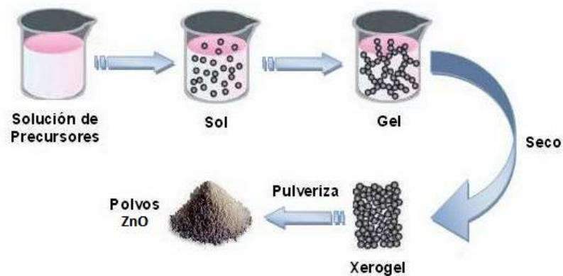
**Figura 2.2.** Esquema del procedimiento general del método sol-gel.
