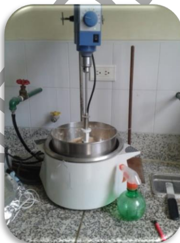
Figura 9. Montaje para hidrólisis enzimática en base seca.
