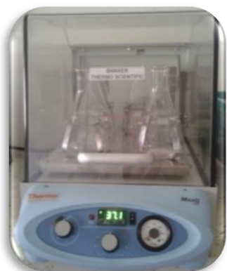
Figura 15. Shaker, equipo con agitación constante y control de temperatura.
