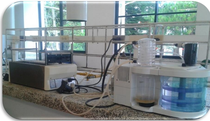
Figura 17. Equipo Kjeldahl, determinación del contenido de nitrógeno total (Proteína).
