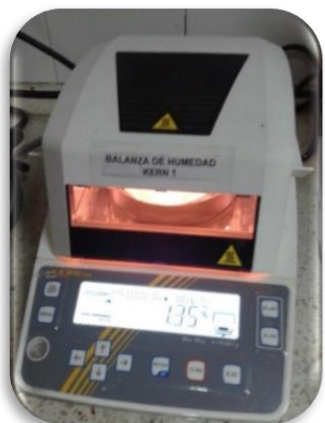
Figura 10. Determinación del % Humedad. Balanza de humedad Kern.
