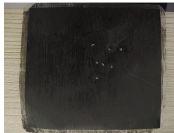
Figura 4.5: Imágenes perforaciones con nailon
