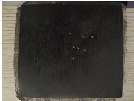
Figura 3.10: Tablero con nailon para calibración relación pixel/mm
