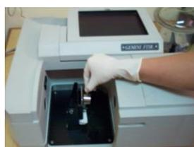
c) Montaje de la muestra en el equipo
