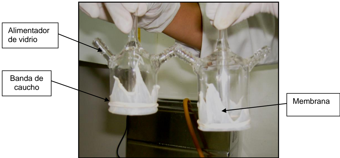
Figura 17. Preparación del alimentador
