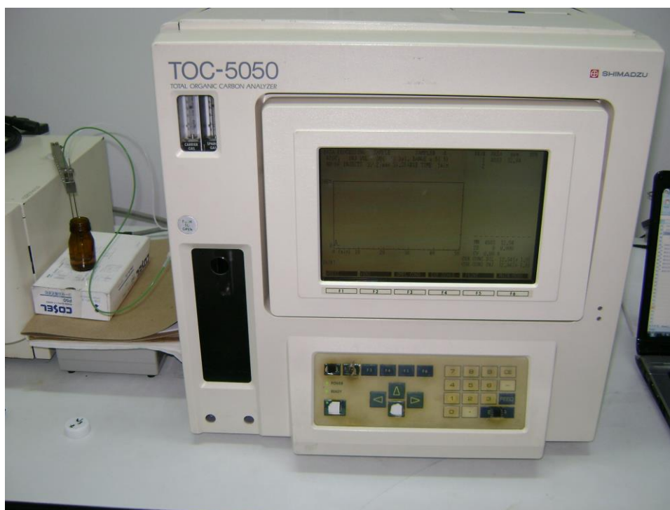
Figura 4. Equipo TOC Shimadzu 5050 con automuestreador ASI 5000.
