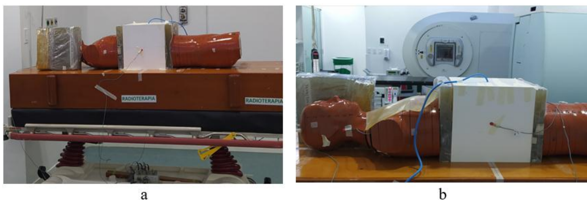
Figura 3-9 Configuración de calibración de diodos como entrada y salida a SSD 3.75m
