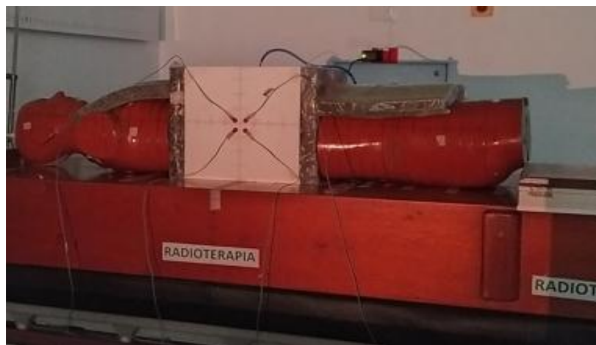
Figura 3-7 Configuración de calibración de diodos como entrada a SSD 3.75m
