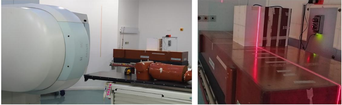
Figura 3-1 Montaje experimental para la medición del perfil de dosis a 3.9m y 4.9m
