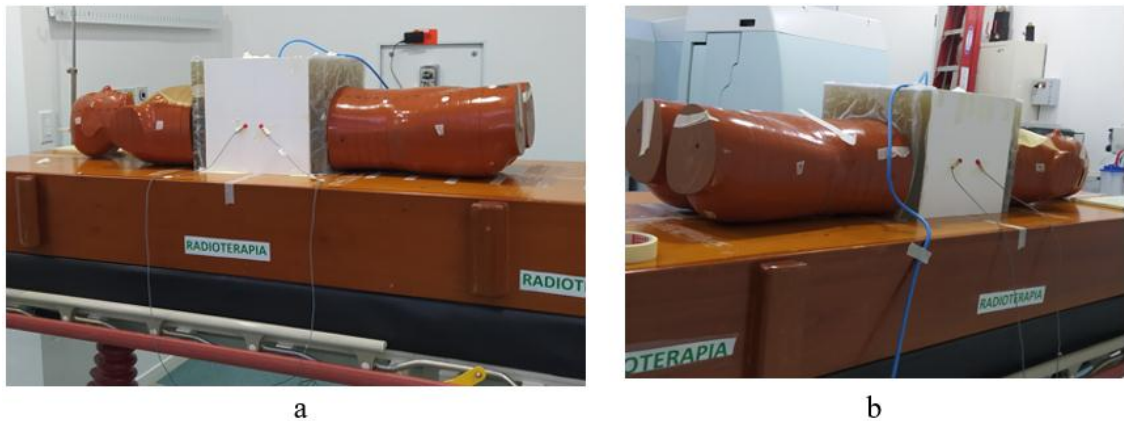
Figura 3-8 Configuración de calibración de diodos como entrada y salida a SSD 3.75m
