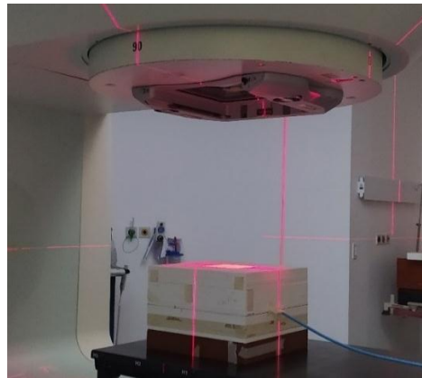
Figura 3-5 Medición de dosis absorbida en el maniqui de agua solididad a 0.1m de profundidad a SSD 1m
