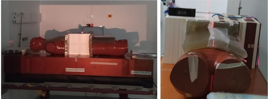
Figura 3-3 Montaje experimental para las medidas de TMR para configuración TBI a 3.9m
