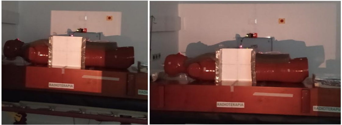
Figura 3-4 Montaje para la medición del factor de dispersión total S_{cp} para un campo de 0.1 \times 0.1 \text{m}^2 de referencia y el campo TBI de 0.25 \times 0.4 \text{m}^2 medidos en el isocentro.
