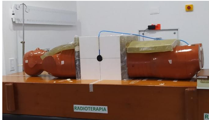
Figura 3-2 Montaje acelerador-maniquí para la medida de PDD para la distancia extendida de 3.9m.
