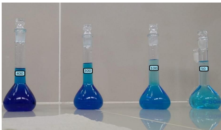
Figura 3.5. Soluciones de azul de metileno usadas para la determinación de la curva de calibración. De derecha a izquierda 400, 300, 100 y 50 ppm.
